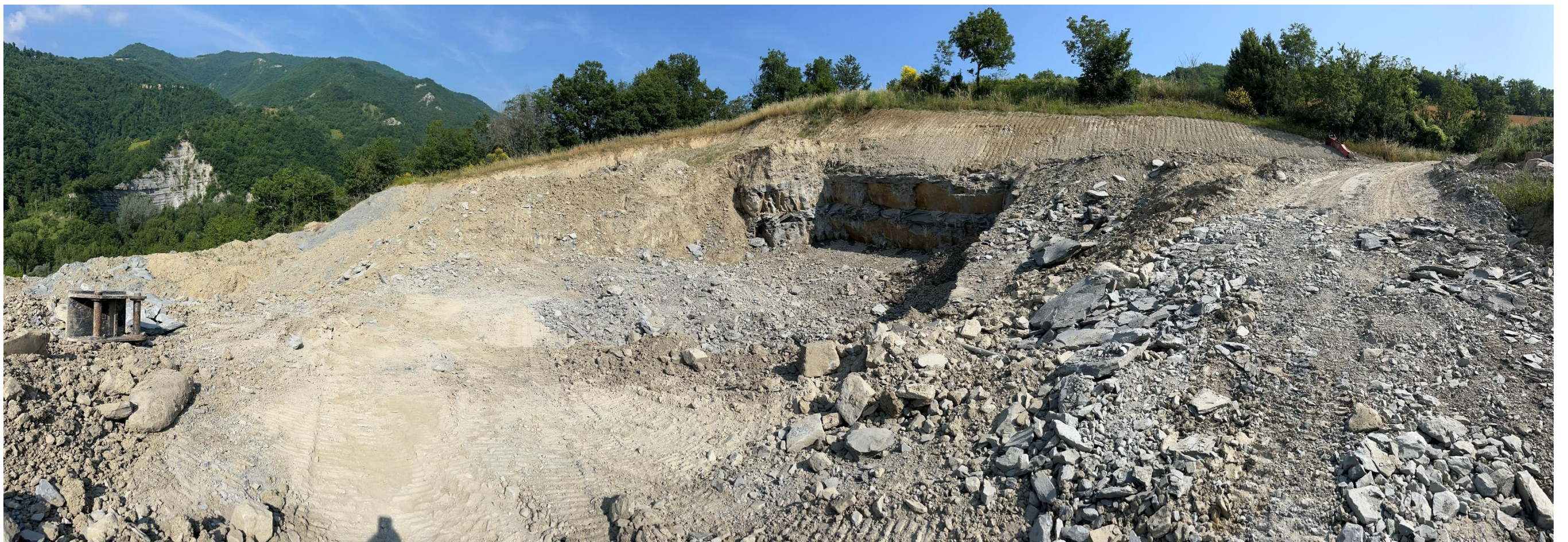
Veduta fronte di scavo cava in atto con evidenti i 2 banchi oggetto di coltivazione
